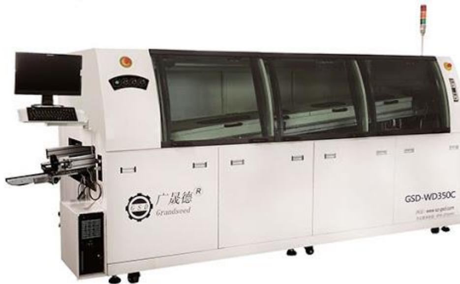
*Ilustración 16 Imagen del tipo de soldadora por ola proyectada. Notes que el operario en ningún momento posee una vía directa de contacto con el interior del equipo. Nótese también el carácter aislante de toda la superficie*
