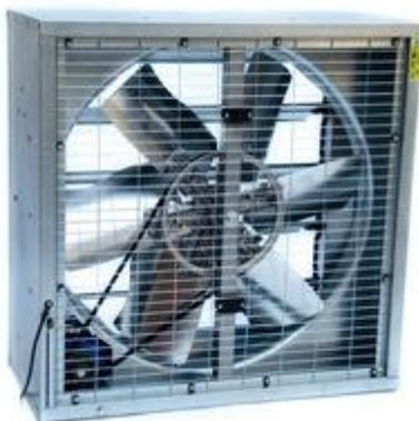
*Ilustración 31 Ventilador extractor similar al proyectado. Nótese la presencia de estructura de montaje y de rejillas en el exterior. Estas se abren y se cierran con el giro del rotor, cerrando la abertura cuando el ventilador se apaga.*
