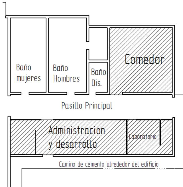
*Ilustración 27 Plano esquemático. Las áreas rayadas son los ambientes climatizados*
