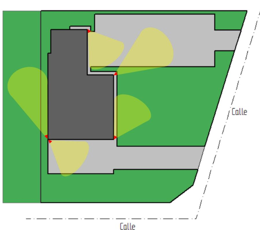
*Ilustración 45 Diagrama ilustrativo de la ubicación de la iluminación exterior. Nótese como cada triángulo rojo representa un reflector, mientras que los amarillo representan los haces de luz ideales*
